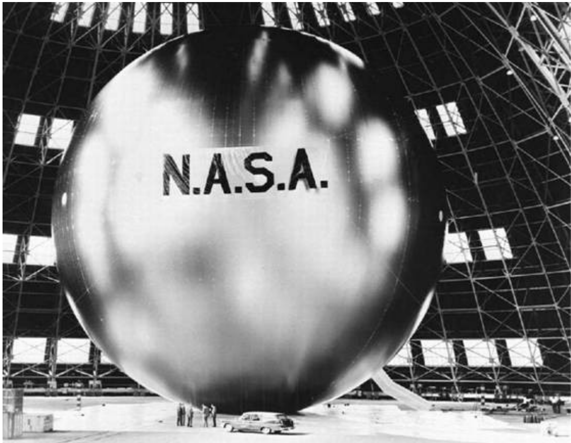
Fig. 2 – Primeiro uso de tecnologias infláveis no espaço. Os primeiros satélites de comunicações da NASA foram feitos com material expansível. Fonte: Bigelow Aerospace.
