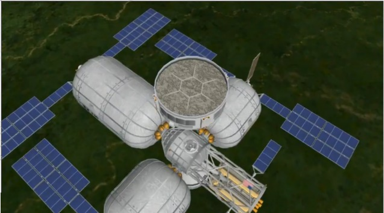
Fig. 3 – Concepção de estação com módulos expansíveis. Confira o vídeo: http://www.youtube.com/watch?v=Mn_gXEK5XmQ&feature=related
